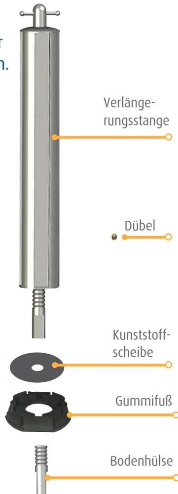
Die vorbereitenden Arbeiten zum Bohren des Lochs für den Einbau der Bodenhülse im Boden müssen nur ein Mal durchgeführt werden. Die Bodenhülse muss mit eingesetzter Stange montiert werden. Dadurch wird sichergestellt, dass die Stange rechtwinklig zum Boden steht und eine sichere Befestigung bietet. Nach dem Aushärten kann die Stange entfernt werden. Die Hülse ist dann bei Bedarf zur Aufnahme der Verlängerungsstange bereit.
